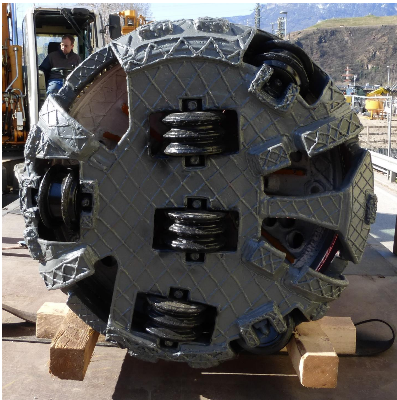
Figura 10-B : MTBM con testa fresante condizionata da "misto pesante" utilizzata nel cantiere di Bolzano
